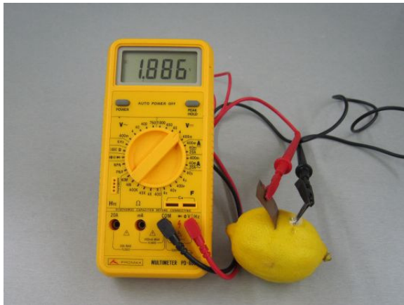
Pila de llimona, un elèctrode de magnesi i un elèctrode de coure.
