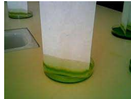
Decantar el líquid en una placa de petri o un vas de precipitats. Posar-hi una tira de paper de filtre...
