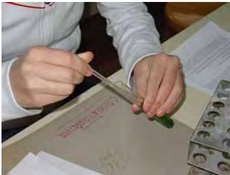
Homogeneitzar-la amb alcohol dins un tub o un morter
