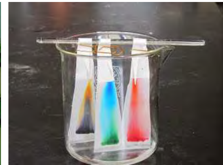
Decantar el líquid en una placa de petri o un vas de precipitats. Posar-hi una tira de paper de filtre...
