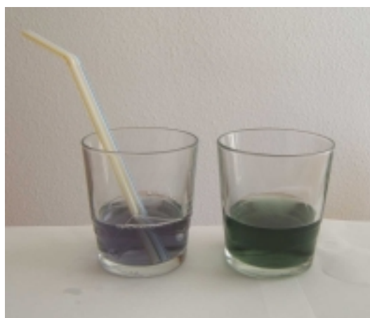
Figura 11.- Cambio de color observado al burbujear dióxido de carbono con una pajita.
