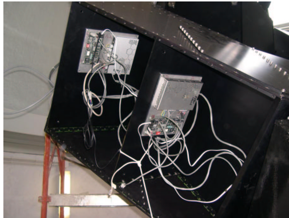
Fig.2: Disposición de dos de las tarjetas de control en la montura del telescopio
